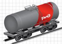
Вагон с резервуаром в виде большого цилиндра называют цистерной. Строят такие вагоны только из металла, предназначены они для перевозки жидких материалов – нефти, бензина, а также пищевых продуктов (растительное масло). Условная масса цистерны – 25 тонн. Грузоподъемность цистерны – 40 тонн.
